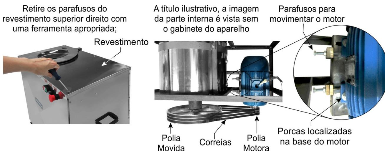
Após concluir todas as regulagens, confira se todas as peças desmontadas estão devidamente montadas e fixadas, garantindo a segurança do operador durante a utilização da máquina.
